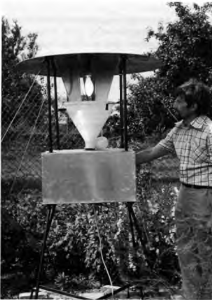
Abb. 1: Lichtfalle bei Klein-Rohrheim. Als Lichtquelle dient eine 150 W Mischlichtlampe. In dem Kasten unterhalb des Fangtrichters befindet sich ein automatischer Probenwechsler, durch den die Fänge einer Woche nach Tagen getrennt werden. Der Bildhintergrund wird durch einen Sommerdeich begrenzt.
